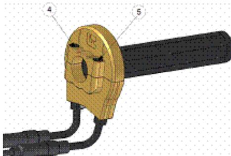
Attenzione: per un corretto montaggio è necessario serrare le viti in modo alternato: dopo averle avvicinate manualmente, avvitare con la chiave la vite (4) facendo mezzo giro, poi passare all'altra vite (5) facendo mezzo giro, ripetere infine l'operazione fino a quando non si raggiunge una coppia di serraggio di 10 Nm MAX su entrambe le viti.
